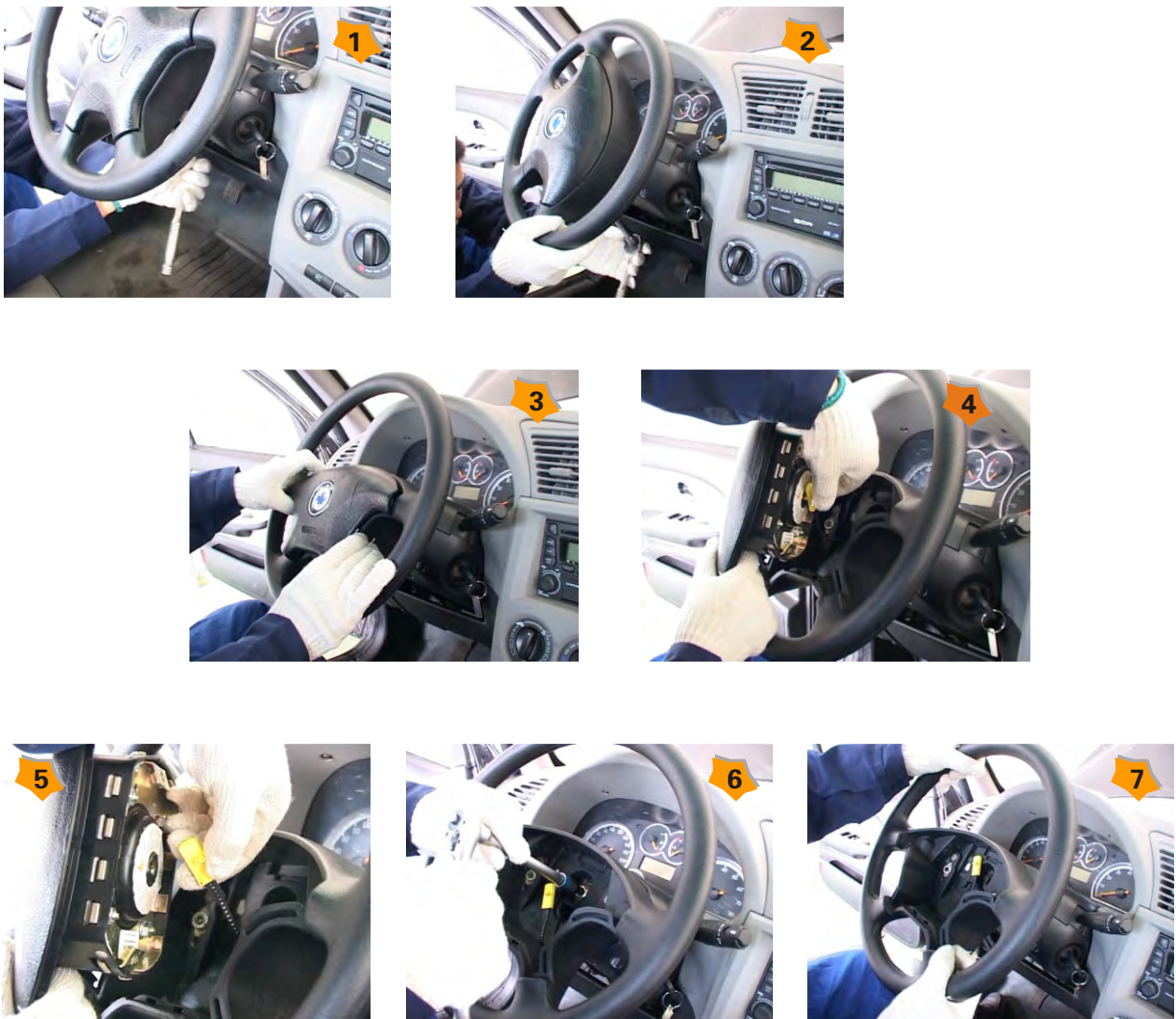
图6-9 方向盘拆卸的过程
