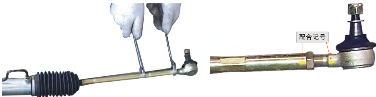
图6-32 转向拉杆球头的安装与调整
