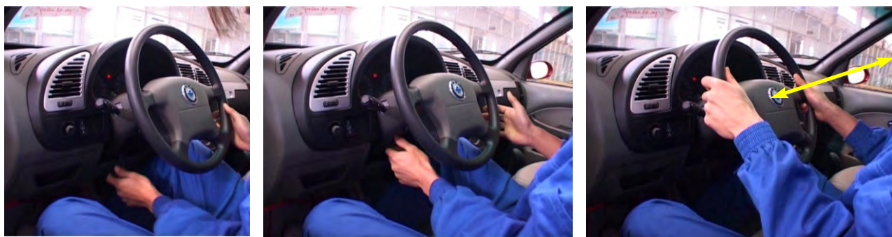
图6-22 方向盘高度调节
